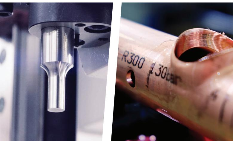
La **S-56 PC** di **T-DRILL** è un gruppo di formatura collarini e punzonatura all'avanguardia che abbina due processi di lavorazione in un'unica unità, garantendo efficacia e precisione senza pari.
